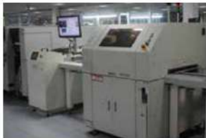
SMT 生产线 (高速双机贴片)
